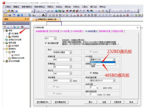
注意: H/W 类型根据 PLC 实际配置 BD 通讯板型号来选择!
